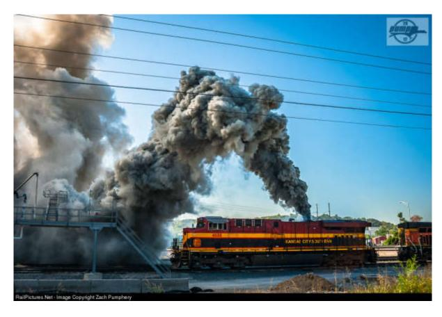
Foto: Una locomotora General Electric ES44AC durante el proceso de embalamiento del motor diesel (Foto de railpictures.net)
