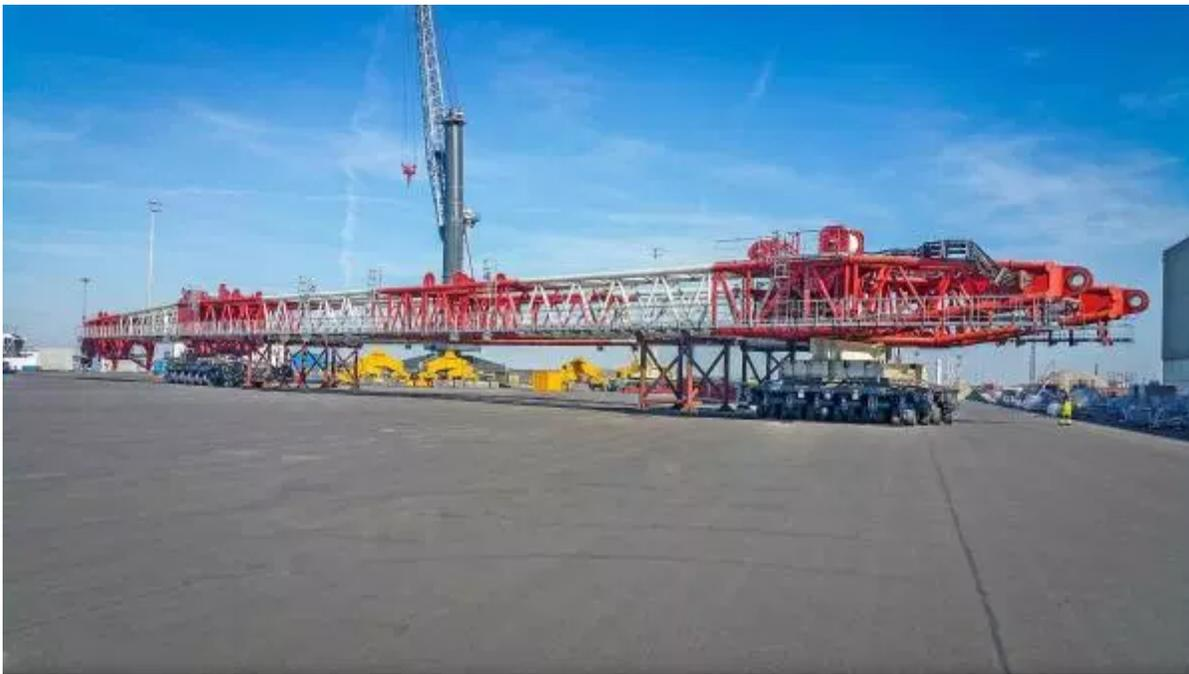
2- El módulo de transporte Cometto MSPE de 48 toneladas moviendo la pluma de una grúa con 105 metros de longitud.
